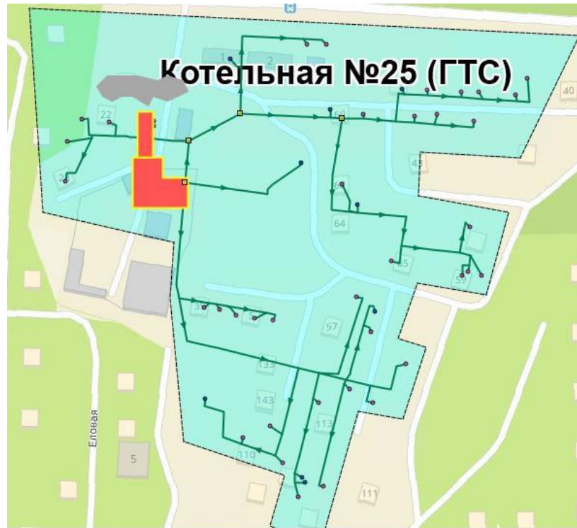
Рисунок 4.17 – Зона действия котельной №25 пос. Лесной СГМУП «ГТС»
